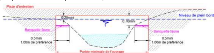
Coupe type d'un ouvrage de type PIPO (extrait du dossier, pièce G3, page 71)
